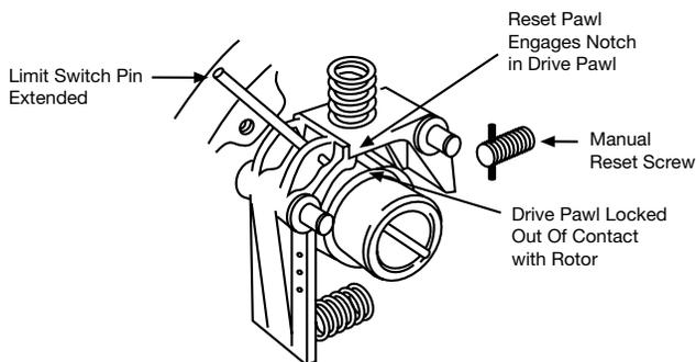
**Figure 2 - Manual Disengaged**
